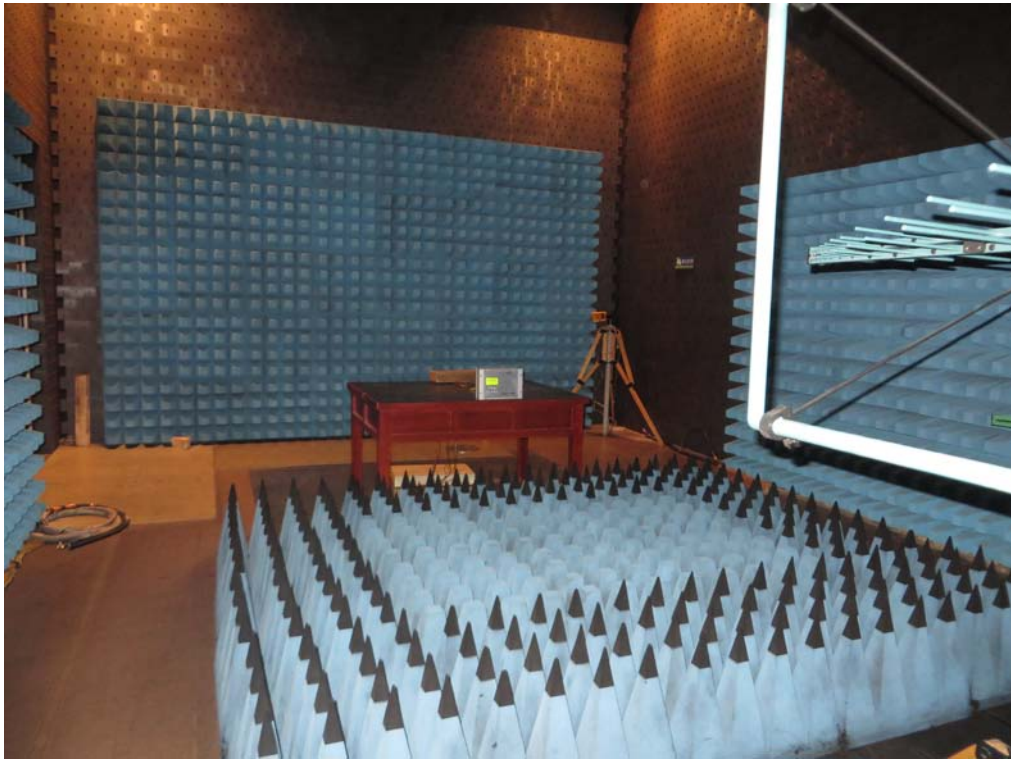
图 3: 射频电磁场辐射抗扰度检验配置图
