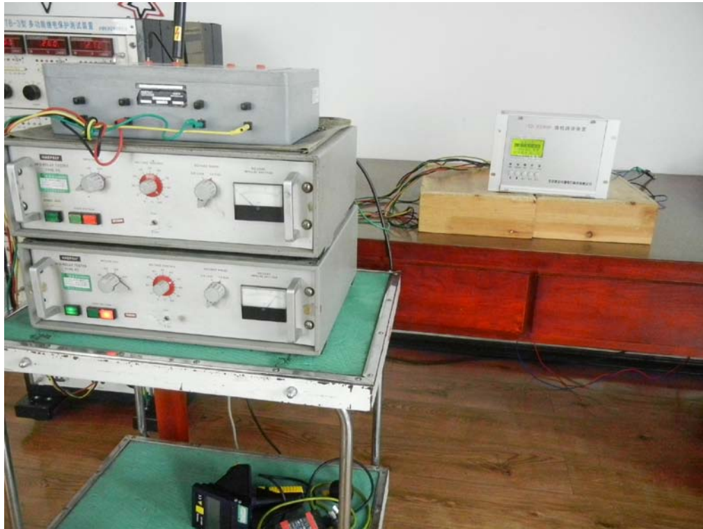
图 1: 1MHz 脉冲群抗扰度检验配置图
